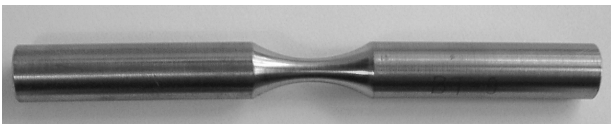
Рис. 1. Образец для испытаний на усталость
